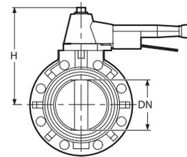
**Дисковый затвор 3800, монтаж между фланцами DIN, ручной редукторный привод, материал — UPVC**
